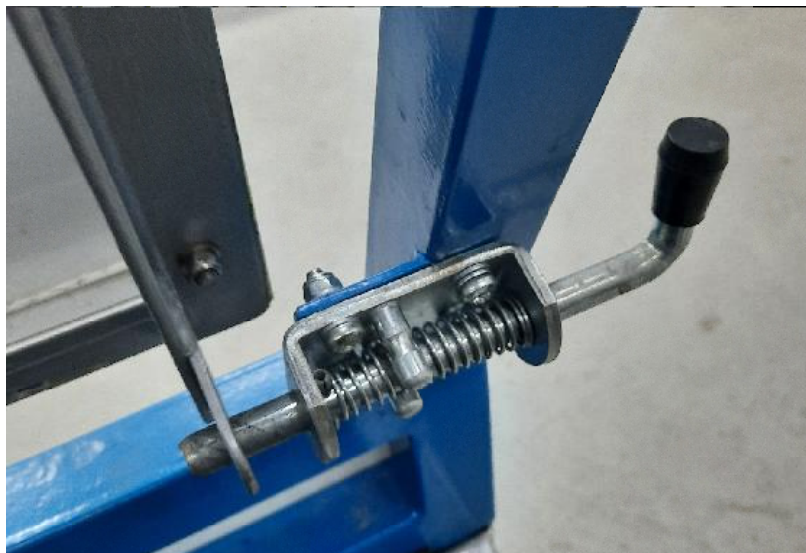
Slika 6 – Detalj - završljivanje panela zasunima s oprugom:
